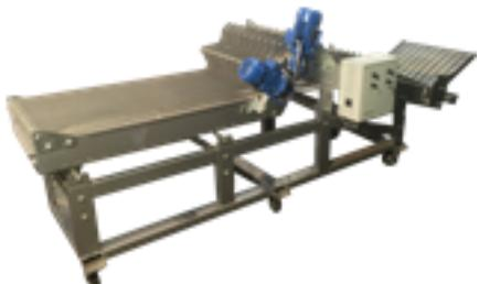
Стеккерная машина предназначена для рассортировки печенья по рядам и постановки его на бок (ребро) для удобства укладки. Многообразие используемых форм печенья на стеккере: овальной квадратной, круглой и прямоугольной. Оборудование помогает оптимизировать процесс упаковки готовой продукции после охлаждения, а частности сократить издержки на заработную плату
