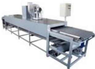
**Конвейер охлаждения КОХ-2** – многосекционный одноярусный охлаждающий конвейер для кондитерских изделий с различной шириной рабочей зоны. Изготовлен с учетом эксплуатации в помещениях с температурой воздуха от 10 до 35°C и относительной влажностью не более 85%.
