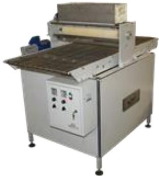
**МП-600** – машина посыпки, предназначенная для декорирования верхней поверхности кондитерских изделий (сахарное печенье, крекер, сушка, кондитерские пласти и т.д.) сыпучей фракцией (сахар, мак, кунжут и т.д.). Машина используется в составе поточных линий формовки и выпечки печенья.
