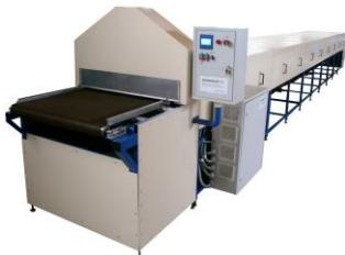
**Печь кондитерская модульная ПКМ** – это современное высокотехнологичное универсальное промышленное оборудование, предназначенное для выпечки кондитерских изделий на сетчатом поде печи. Печь изготовлена с учетом ее эксплуатации в помещениях с температурой воздуха от 10 до 35°C и относительной влажностью не более 85%.
